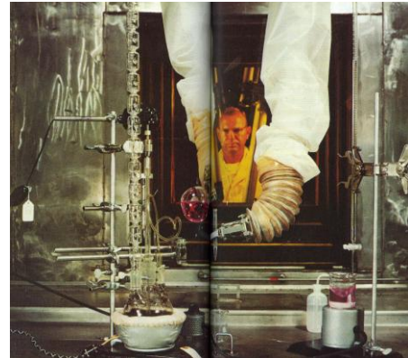
Figuur 9 – Met handling tools achter een afscherming van bijvoorbeeld loodglas zijn bewerkingen op afstand uit te voeren.
