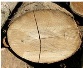
Figuur 1 – De natuurlijke groei van een boom veroorzaakt een 'interne spanning' in het hout van de stam. Als het hout na het kappen begint te drogen, kan deze interne spanning groter worden dan de sterkte van het hout. Daardoor gaat het hout scheuren.
