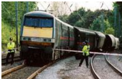
Figuur 7 – Een treinongeluk als gevolg van railbreuk.
