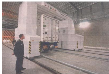
Figuur 11 – Container-scanner in de haven van Rotterdam.
