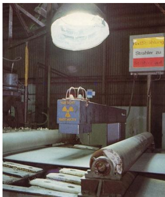
Figuur 15 – Diktecontrole met een radioactieve bron.
