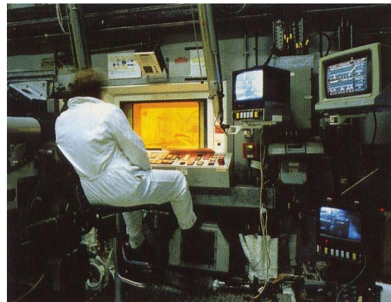
Figuur 20 – Manipuleren van radioactieve bronnen met mechanische armen of handling tools (links) van achter een afscherming van loodglas (rechts).
